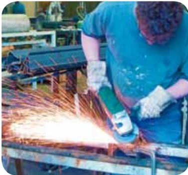
**Schrupscheiben Silverstar „Stahl, Grauguss“, grinding wheels steel, grey cast iron**
