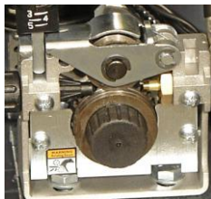
Kraftvoller Drahtvorschub mit verzahntem 2-Rollenantrieb
