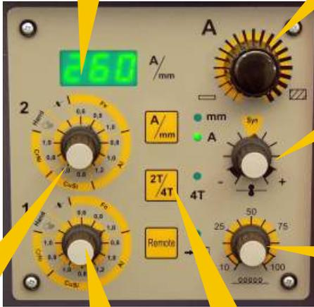
**Stufenlose Einstellung** - keine Spannungsstufen, keine verwirrende Unterteilung in Grob und Feinstufen. Direkte Einstellung als Materialdicke (mm) oder Schweißstrom (Ampere)
