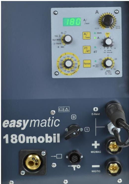
**Komfortable Steuerung:** Mit Synergieprogrammen für 12 Materialien, WIG- und E-Handprogramm. Einfachste Einstellung z.B. über Materialdicke in der Anzeige (in mm). Einstellbares Drosselsystem (DDc).
