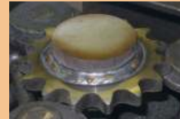
Zahnrad für Holzbearbeitungsmaschinen mit promatic 350W geschweißt.
